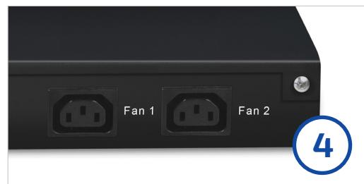
Подключите одно или два вентиляторных устройства к розеткам FAN1 или FAN2 с помощью дополнительных шнуров питания
