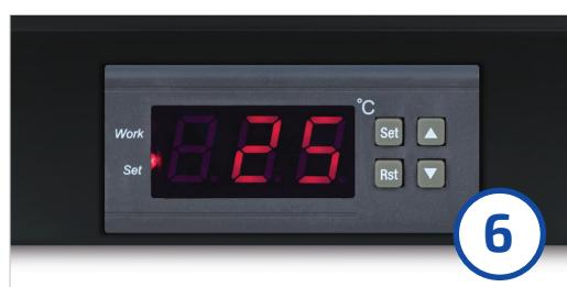
После включения нажмите кнопку **Set** один раз для ввода температуры срабатывания контроллера.
