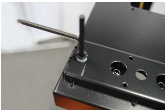
Для установки регулируемых опор (ножек) вначале выкрутите защитные заглушки из 4 отверстий в нижней части шкафа.
