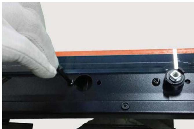
Установите ручку с замком двери и зафиксируйте ее самонарезающими винтами ST5,5x10. Для затяжки соединений используйте шестигранный ключ с соответствующим наконечником.
