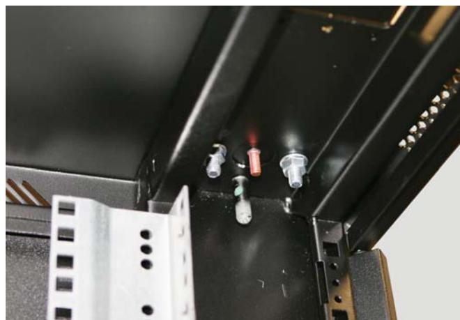
Металлические элементы шкафа – каркас, крыша и основание, боковые панели, передняя и задняя двери – оснащены узлами заземления в виде резьбовых шпилек (или болтовых соединений).
