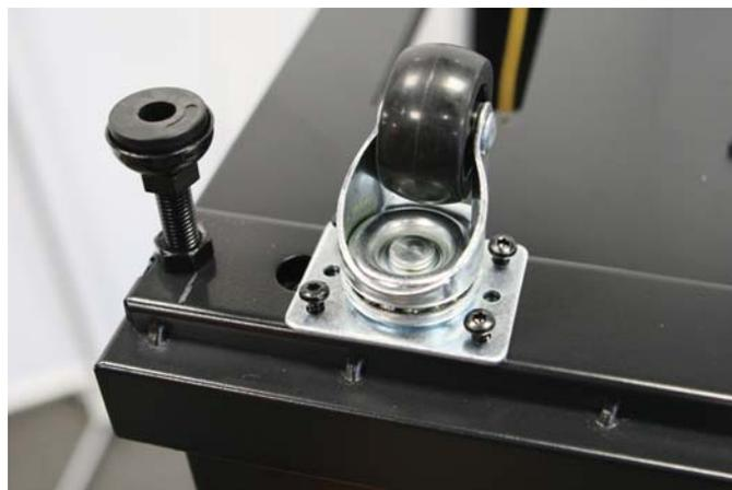
Вкрутите в соответствующие отверстия 4 регулируемые ножки. Убедитесь в надежной фиксации соединений гайками.
