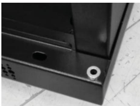
Установите дистанцирующую шайбу (дверное кольцо) на соответствующее отверстие в нижнем углу каркаса.
