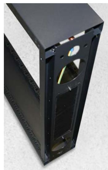
Щеточный кабельный ввод поставляется уже прикрученным к одной из рам каркаса. Его положение можно выбрать на этапе сборки каркаса. Для этого поверните соответствующую раму в нужном вам направлении, чтобы щеточный ввод был размещен сверху или внизу шкафа. В дальнейшем, при необходимости, щеточный ввод можно будет переустановить в другое подходящее штатное место.
