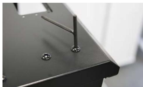
При соединении верхней панели с рамами каркаса вначале вставляйте винты М8 в отверстия, размещенные ближе к центру шкафа. Каждый винт затягивайте гайкой М8.
