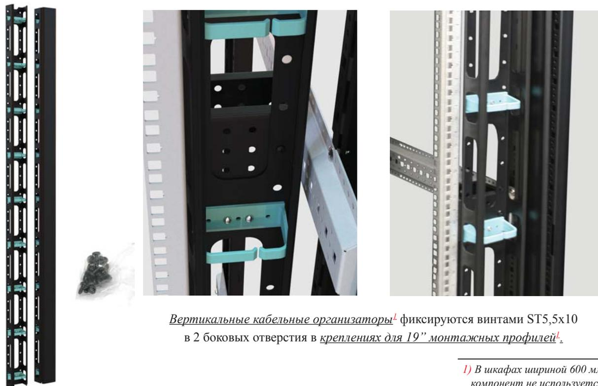
*Вертикальные кабельные организаторы<sup>1</sup> фиксируются винтами ST5,5x10 в 2 боковых отверстия в креплениях для 19" монтажных профилей<sup>1</sup>.*
