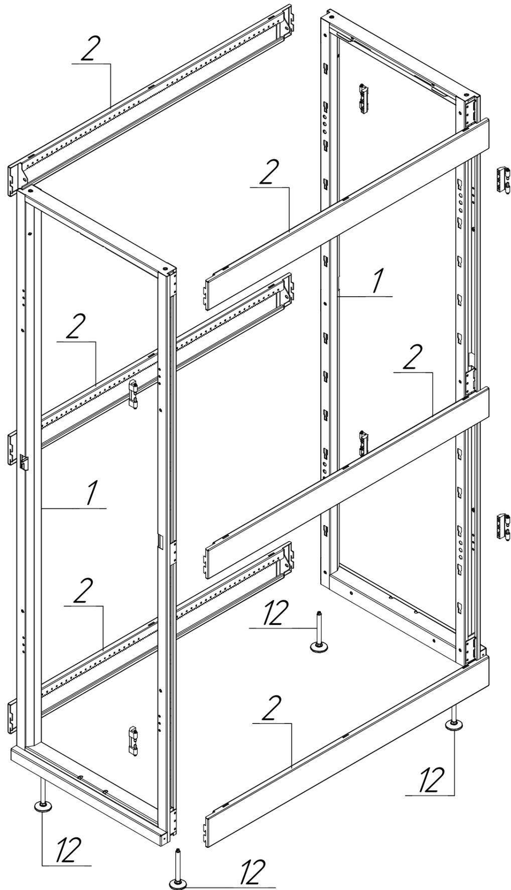
1. Вкрутить Опоры регулируемые (п.12) в Рамы (п.1), предварительно накрутив на них Контрзайки (п.15). рис.1а
