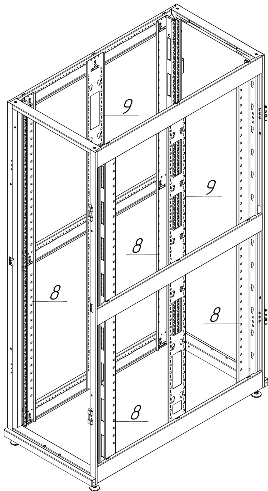
1. Установить на 19" монтажные профили (п.8) и Кабельные организаторы (п.9) Фиксаторы (п.10), с помощью Винтов (п.14). рис.2а
