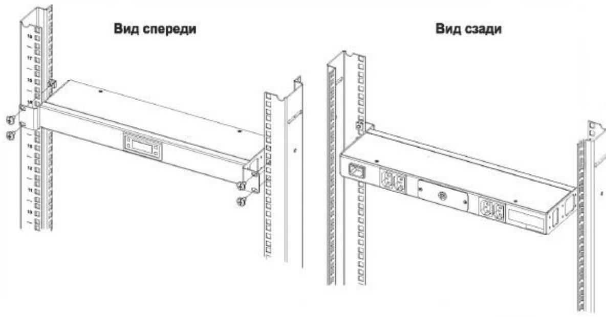
Термодатчик размещен в кармане на тыльной поверхности изделия. Карман закрыт панелью с отверстием.
