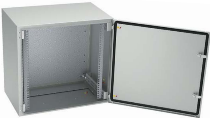
Шкаф SWN IP65 с монтажной панелью и 19-дюймовыми монтажными профилями, окрашенный порошковой краской цвета RAL 7035. Внешние размеры: высота 575x600x400 мм (ВxШxГ). Полезная высота 12U. Исполнения со сплошной дверью и металлической со стеклом
