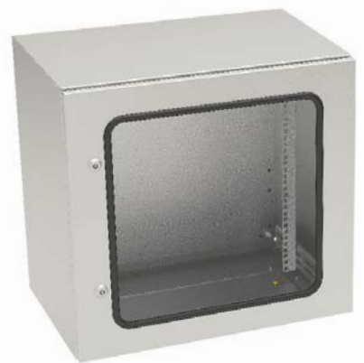
Шкаф SWN IP65 с монтажной панелью и 19-дюймовыми монтажными профилями, окрашенный порошковой краской цвета RAL 7035. Внешние размеры: высота 575x600x400 мм (ВxШxГ). Полезная высота 12U. Исполнения со сплошной дверью и металлической со стеклом
