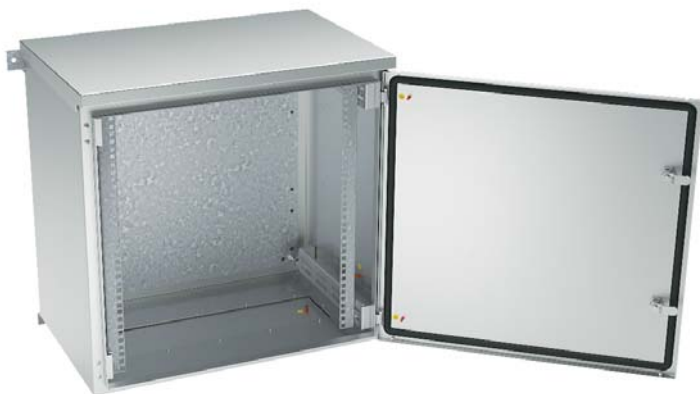
Шкаф SWN IP65 с монтажной панелью, 19-дюймовыми монтажными профилями и защитной крышкой от воздействия осадков, изготовленный из нержавеющей стали. Внешние размеры: высота (с крышкой) 606 мм, ширина 600 мм, глубина 400 мм. Полезная высота 12U
