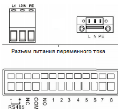
Рис. 2.1 Интерфейс подключения (данные о порте энергопровода содержатся в указаниях на заводской табличке с паспортными данными)
